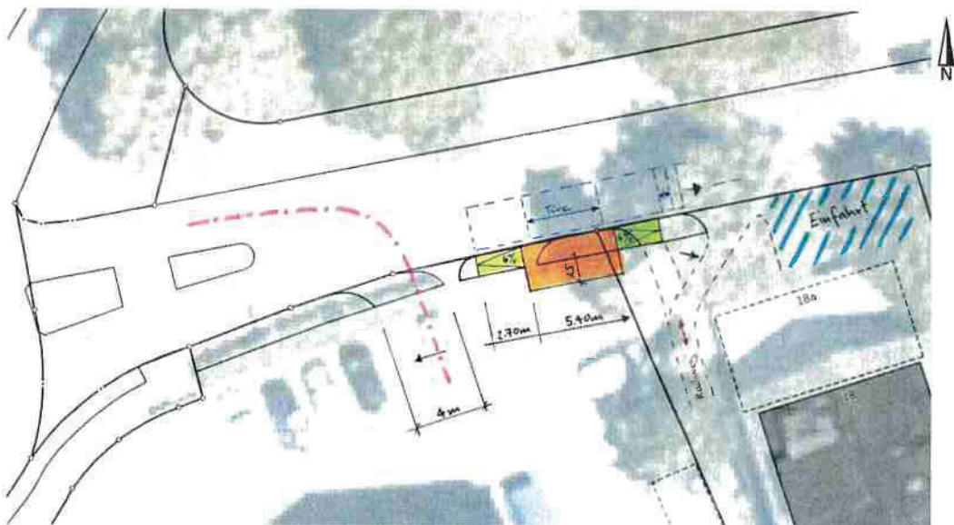
Abbildung 3, Situationsskizze der Massnahmen Haltestelle Sonnenhof Richtung A
